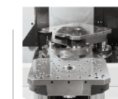
Automatic Pallet Changer with two pallets 自動交換工作台 - 二個工作台
